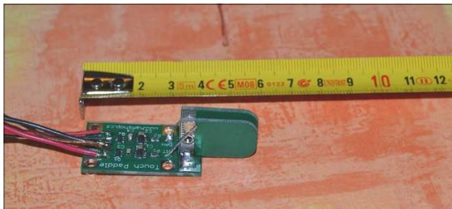
Il faut souder verticalement les 2 palettes puis les relier aux contacts DIT et DAH. L'alimentation se fait sous 3 à 5 volts (plots à souder + et - ) Un petit boîtier contenant 2 piles rondes fera l'affaire. Les 3 autres points de soudure pour le cordon de liaison sont répertoriés RING, GND et TIP (voir schéma pour ceux qui
